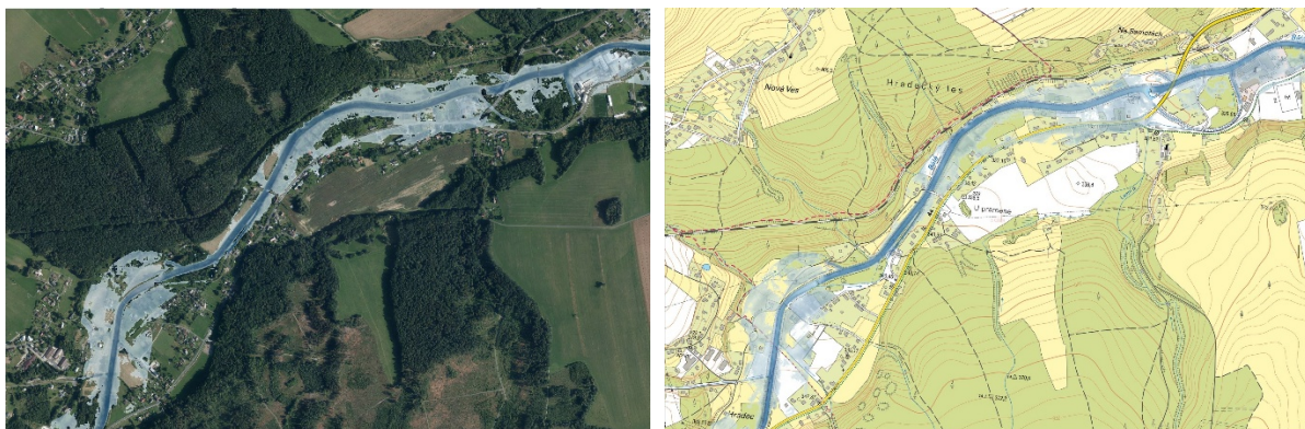
Obr. 2.4.2 Ukázka ze simulace kulminační hladiny a rozlivů povodně pomocí hydrodynamického modelu na Bělé u Mikulovic.
